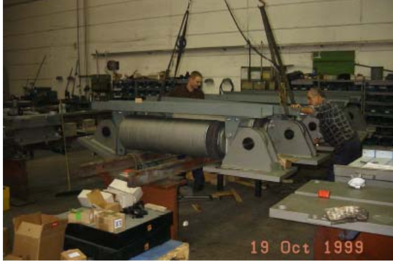
Şekil 3: Alpera Viyadüğünün hidrolik damperleri
